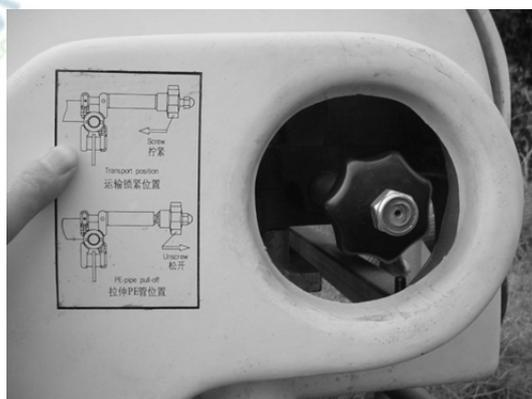
结束灌溉：在 PE 管回收完毕后，继续喷灌 5 分钟，然后关闭给水栓或水泵，将连接软管与水栓脱开。该地块灌溉结束，此时将刹车装置的锁紧手轮顺时针转动拧紧至“运输锁紧位置”。可移动机器至下一灌溉位置。
