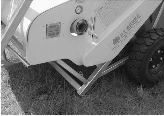
4. 把两个支撑板压入地面，使喷灌机在工作时保持稳定及 PE 管回收结束时实现自动停车。若地面较硬，必须掘出足够深的坑以放下支撑板。
