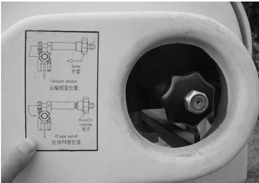
5. 将刹车装置的锁紧手轮逆时针转动退出至与锁紧螺帽接触的“拉伸 PE 管位置”。
