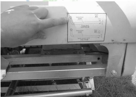
6. 将关闭杆推至并固定在“拉伸 PE 管位置”。
