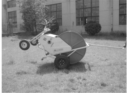
2. 根据作物种类及工作区域的实际情况，设定喷水行车的轮距。喷水行车必须对称连接，轮距调整范围：1200—1800mm。
