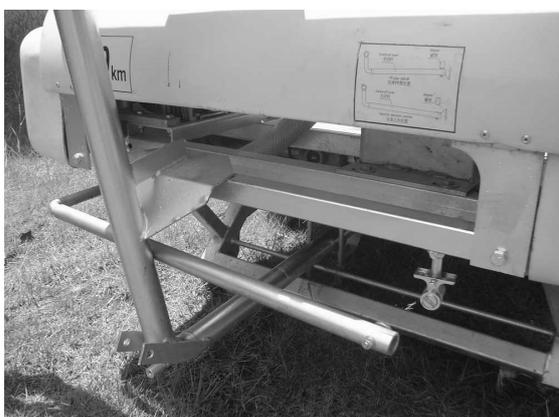
13. 喷水行车回收至主机前触动到关闭杆，离合器自动脱开，从而结束回卷过程。如中途停止喷灌，回收 PE 管须靠人力回转卷盘。
