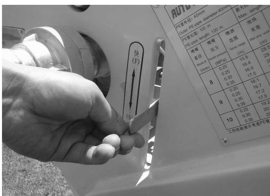
12. 当入机压力达到工作压力并喷灌 5 分钟后，慢慢调整水涡轮调速板，使卷盘转动。继续调整至喷水行车达到预定的回收速度。
