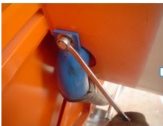
拆下出水弯头
