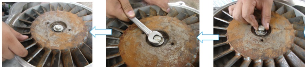
旋转叶轮确认紧固度
