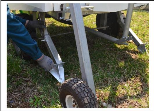
4. 取下锚桩挂板并把两个锚桩头压入地面，使喷灌机在工作时保持稳定及 PE 管回收结束时实现自动停车。若地面较硬，必须掘出足够深的坑以放下锚桩头。
