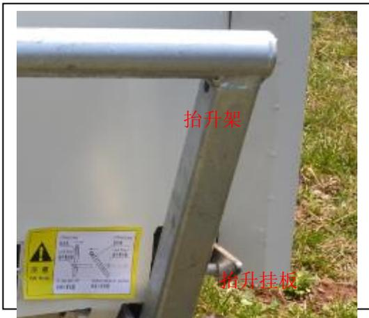
6. 确认抬升挂板已锁紧抬升架,方可将喷水行车拉出。
