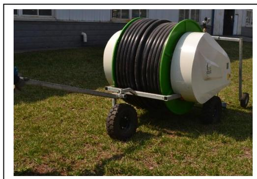
2. 根据作物种类及工作区域的实际情况，设定喷水行车的轮距。喷水行车必须对称连接，轮距调整范围：1200～1800mm。
