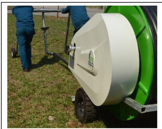
7. 拉伸 PE 管：喷水行车拉出时，最大速度不得超过 1000 m/h。操作者在喷水行车将要拉到尽头时，应减缓牵引速度，并注意观察卷盘，当卷盘上所留 PE 管至少两圈时，须停止牵引。
