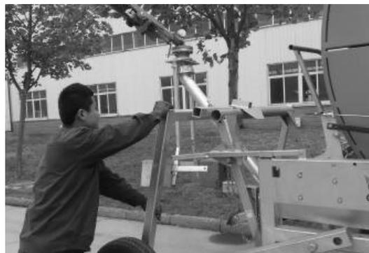
5. 抬起锁定杆，缓慢压下变速杆放松 PE 管使喷水行车缓缓落下。喷水行车落到地面后，将变速杆放置并固定在“PE 管铺设”位置。
