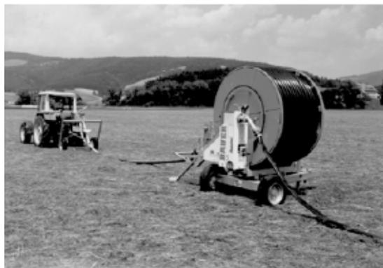
9. 用软管连接喷灌机进水弯头。
