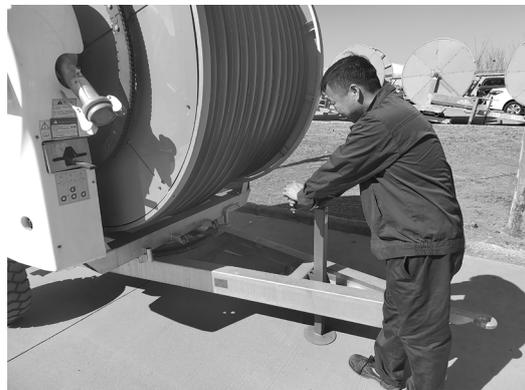
2. 取下回转支撑定位销，旋转喷灌机，使喷水行车正对灌溉带的方向，再用定位销将回转支撑固定。
