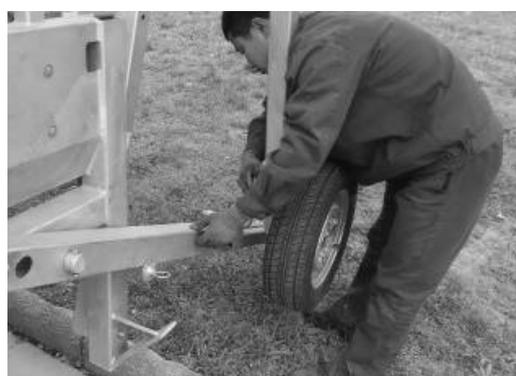
4. 根据作物种类及工作区域的实际情况，设定喷水行车的轮距，并用顶丝紧固。喷水行车必须对称连接，轮距调整范围在 1.5m—3.5m。
