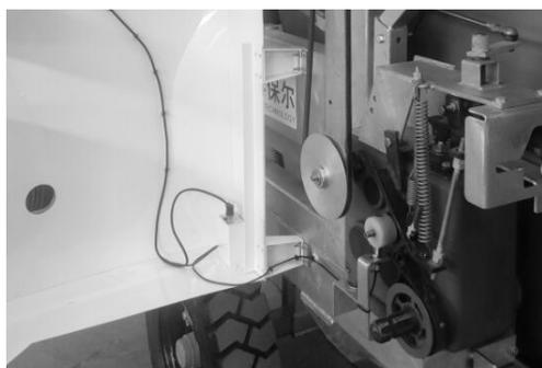
12. 喷水行车回收至主机前，关闭杆将喷水行车抬升，同时变速箱自动脱档，从而结束回卷过程。PE 管回收完毕后，继续喷灌 5 分钟，然后关闭给水栓或水泵，将连接软管与水栓脱开。
